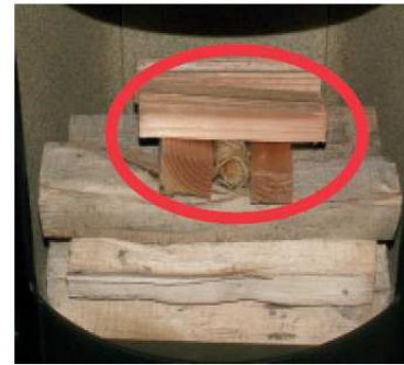
Breite Feuerräume mit wenig Tiefe befüllen Sie mit der Längsseite nach vorne.
