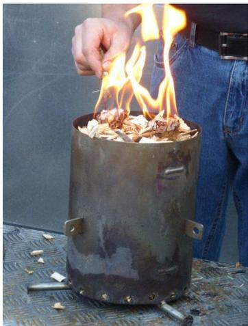
Ein Pyrolyseofen wird immer von oben angezündet. Das heißt, der Ofen brennt von oben nach unten.
