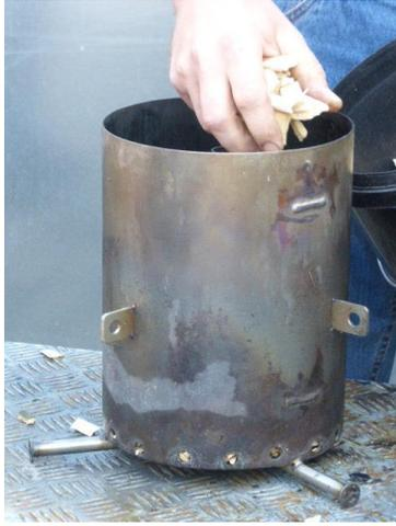
Brennstoff: Zerkleinertes Holz oder Strauchschnitt bzw. Hackschnitzel
